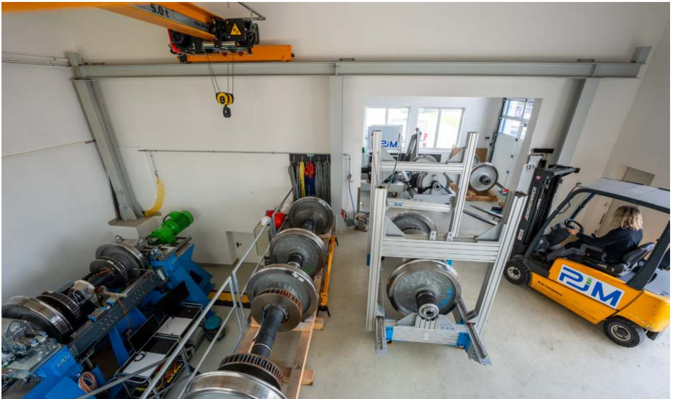
Die Infrastruktur im Bereich Messradsätze umfasst u.a. einen stationären Prüfstand, einen dynamischen Prüfstand sowie entsprechende gerätetechnische Ausstattung wie Hallenkran. Credit: Manuel Hanschitz für PJM, honorarfrei
